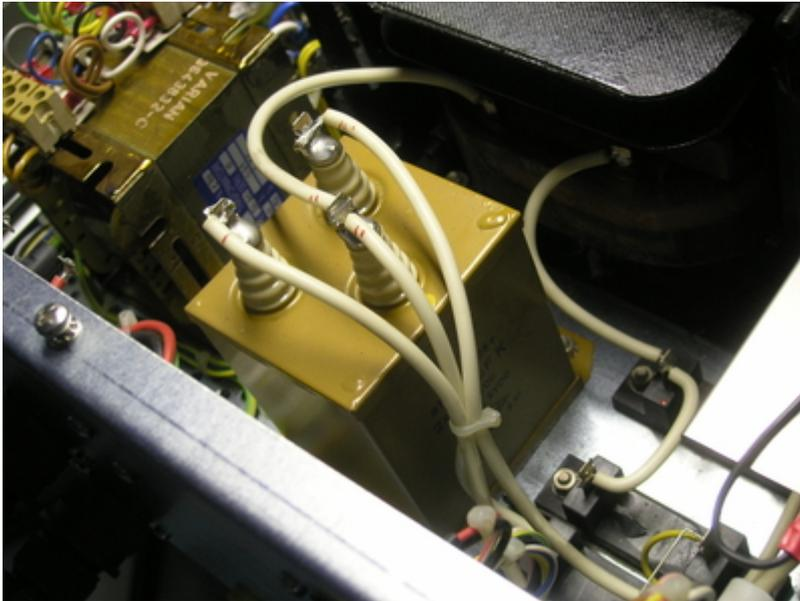
Auf einem frei am HV-Trafo hängenden Alublech ist ein Temperatursensor mit zwei Anschlüssen montiert. Der schaltet das Gerät ab, wenn die Lastwiderstände zu Glühröhren mutieren:
