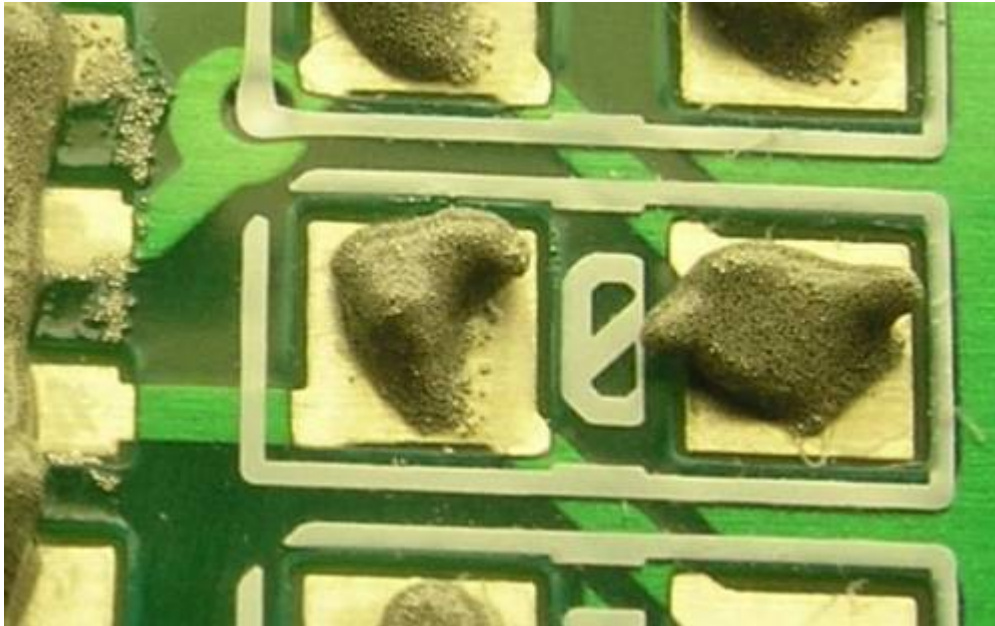
Im Makro-Foto sieht man die Metallkügelchen der Lötpaste
