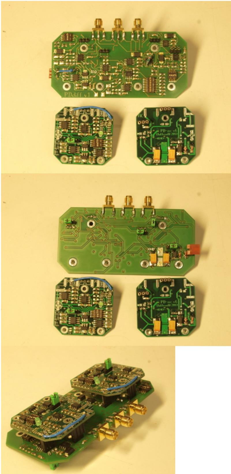
Die blauen Kabel auf der PDac Platine dienen der Übertragung des PDac-DC Signals auf die PDiff Platine. Auf der Unterseite der PDiff Platine sind Jumper angelötet, mit denen man zwischen dem AC und dem DC Ausgang der PDac Platine wählen kann.
