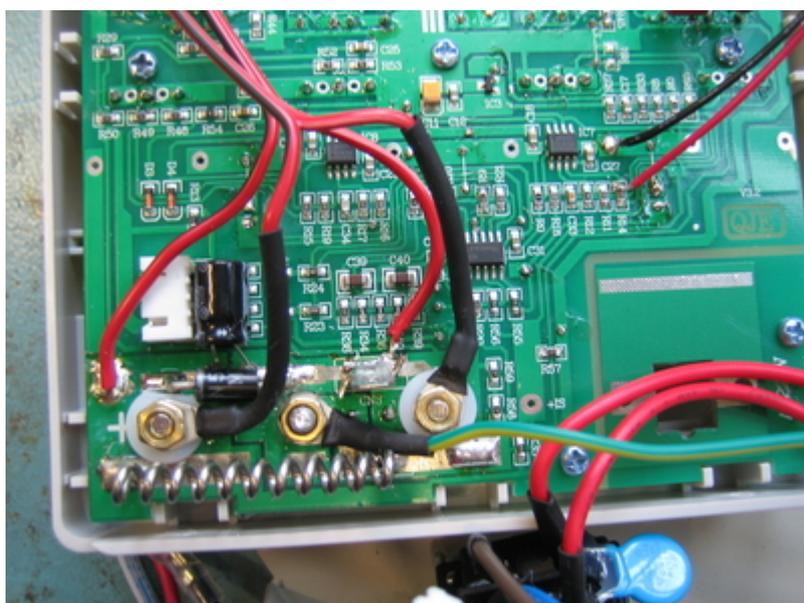
Kabelschuh auf grün-gelbes Kabel krimpen und Kabel festschrauben. Anschließend Stecker wieder anstecken und abgelötetes rotes Kabel wieder anlöten.
