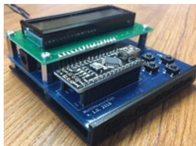
Eine Bodenplatte steht als 3D-Druckvorlage zur Verfügung.
