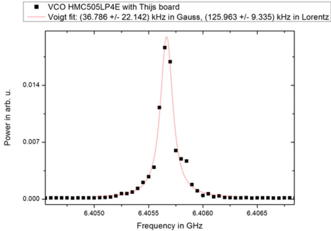
Die Frequenz des VCO blieb dabei über längere Zeit stabil, also über Stunden innerhalb eines Bereiches von < 1MHz.
