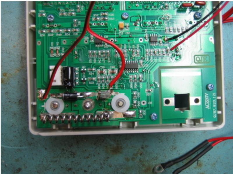
Platine wieder auf die Gehäusevorderseite schrauben und jeweils eine Isolier-Unterlegscheibe auf den positiven und den negativen Ausgang legen, wobei die Unterlegscheibe für den positiven Ausgang angepasst werden muss.
