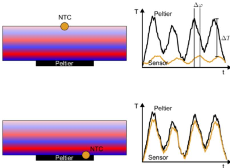
Übertragung von Temperaturschwankungen durch ein Lasergehäuse
