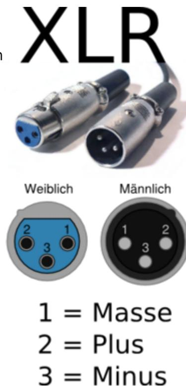
Am Endgerät sollte ein Einbaustecker montiert werden (male). An einem Netzteil, oder einem Verteiler sollte eine Einbaubuchse (female) eingebaut werden. Der Grund ist, dass fertig konfektionierte Kabel grundsätzlich als Verlängerung von Buchse auf Stecker verkauft werden (male-female).
