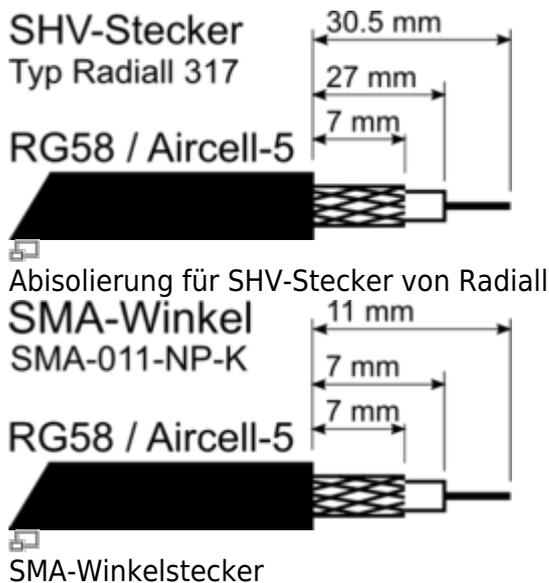
Kabel alleine sind nur die halbe Miete. Sie müssen in irgend einer Weise mit Steckverbindern verbunden werden. Es lohnt, sich die Empfehlungen der Hersteller der Steckverbinder zu befolgen. Viele Schummeltricks funktionieren erstmal, führen aber auf die Dauer zu Wackelkontakten.
